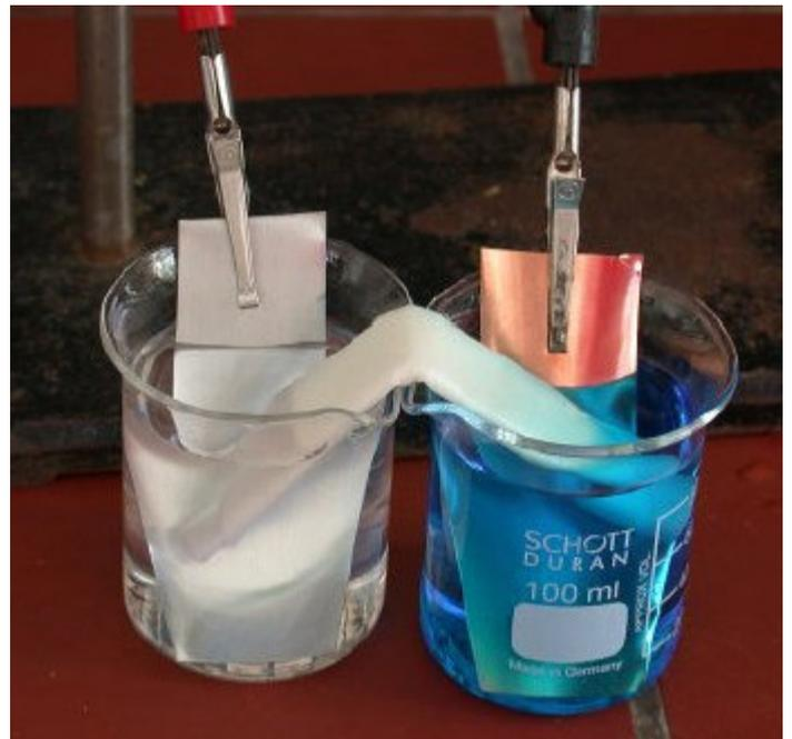
Verändere als nächstes den Versuchsaufbau, indem du den Stromkreis **ohne** Messgerät schließt und die Versuchsanordnung bis zum nächsten Tag stehen lässt. Spüle dann die Bleche gut mit Wasser ab und bestimme jetzt erneut die Masse der Bleche.
